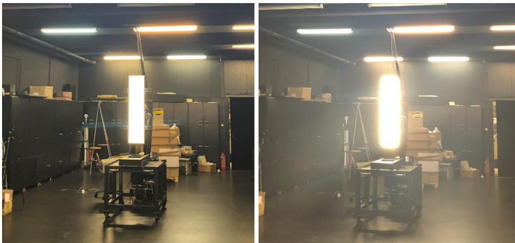
Εικόνα 2: Αύξηση στη τροφοδοσία της τάσης ελέγχου από την ελάχιστη τιμή των 0V (αριστερά) προς τη μέγιστη τιμή των 10V (δεξιά).
